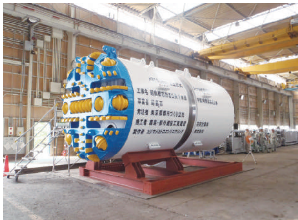
雨水幹線の築造に使用した外径3080mm泥土圧式シールド掘進機（昭島市）
