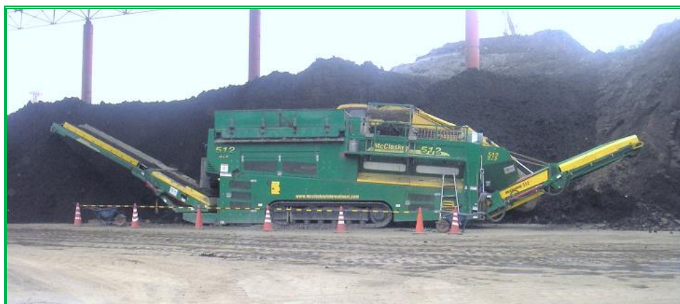
搬入土をバックホウで投入し稼動状態のマシン
